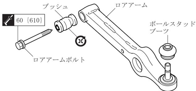
$\text{N} \cdot \text{m}$  { $\text{kgf} \cdot \text{cm}$ } 締付トルク 再使用不可部品
