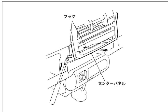
(2) センターパネルの下側か ⊖ ドライバーなどでフック(A)を押し、センターパネルの下側を手前に引き出します。
