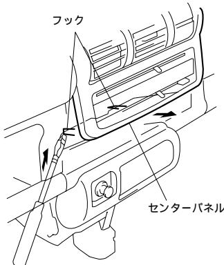
(2) センターパネルの下側か $\ominus$ ドライバーなどでフック(A)を押して外し、センターパネルの下側を手前に引き出します。
