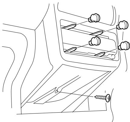
(1) センターパネルの下側からスクリュー1本を外し、ヒーターコントロールユニットからノブ(4ヶ)を外します。
