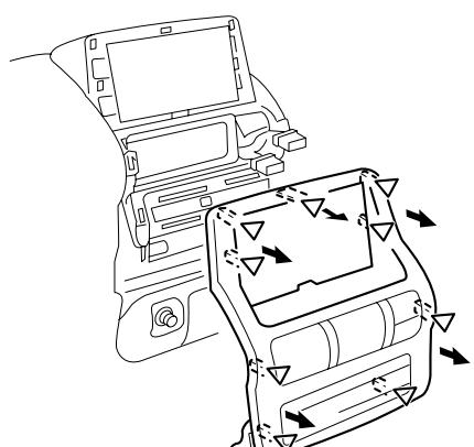
(3) センターパネルのタブ・クリップを外し、コネクター類を外し、センターパネルを取り外します。
