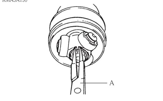
2. シャフトのグリースを落とし、特殊工具を使用して、スナップリングを取り外し、ジョイントをシャフトから取り外す。
