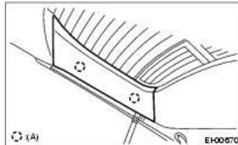
2. クリップを外し、リヤゲートアップトリムを取外す。
