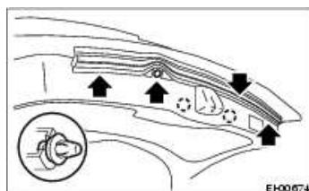
5. クリップ (A) を外し、リヤゲートロアトリムを取外す。
