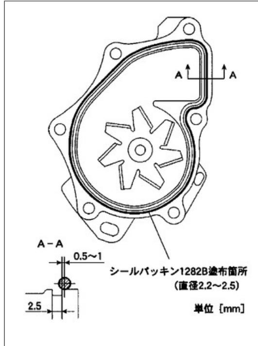
ウォータポンプの溝部の外側に沿って、シールパッキン1282B(直径2.2~2.5mm)を塗布する。
