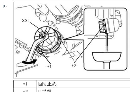
SSTを使用して、オイルフィルタキャップを約4回転緩め、キャップリブ部を上下方向に合わせ、キャップ内部のエンジンオイルを排出させる。
