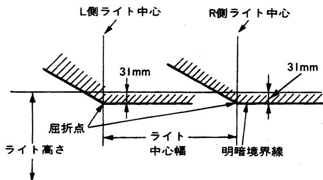
\* 屈折点は片側ランプの光軸をしゃ断することにより明確になる。
