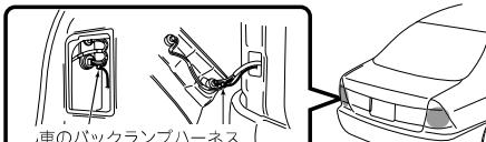
※リバース信号端子を接続しないと車両を後退させた際に自車位置のズレが発生する恐れがあります。
